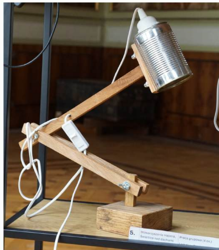
Autor — Stowarzyszenie Hajstra, Świetlica nad dachami Tytuł pracy — Lampka „rozświetl mnie” Wykorzystane materiały: listewki z odpadów stolarskich, puszka po konserwie, kabel z oprawą, śruby i nakrętki
